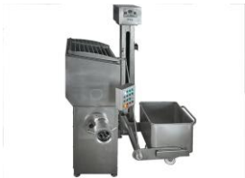
Волчок мешалка ДВАК В-160МК с загрузчиком
