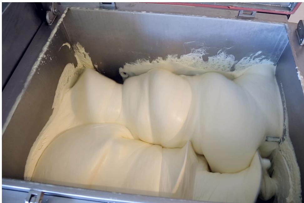
**Изготовлен из нержавеющей стали**, марки, допущенной к контакту с пищевыми продуктами.
