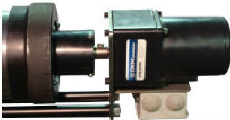
Привод вращения магнитной планшайбы (Мотор-редуктор)
