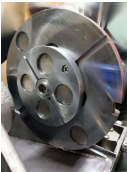
Малая планшайба для заточки ножей и решеток мясорубок и другого режущего инструмента размером от 50 до 80 мм на станке СЗВ-03
