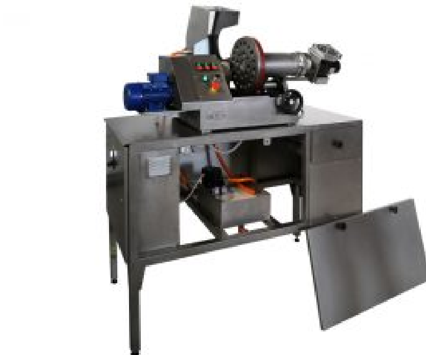
Стол, Система оборота охлаждающей жидкости СОЖ внутри стола заточного станка ДВАК СЗВ-03/04
