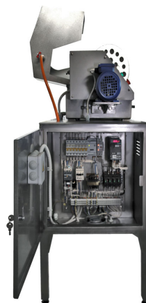
Частотный регулятор в боковой части стола заточного станка для волчкового инструмента ДВАК СЗВ-03/04
