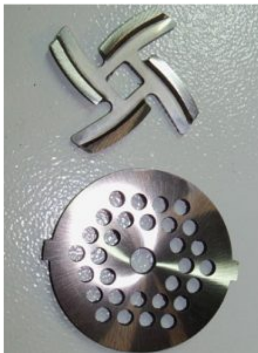
нож и решётка мясорубки, заточенный на СЗВ-03 с применением дополнительной малой магнитной планшайбы
