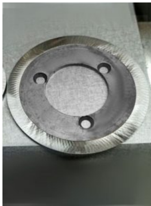
малый дисковый нож, заточенный на СЗВ-03 с применением дополнительной малой магнитной планшайбы
